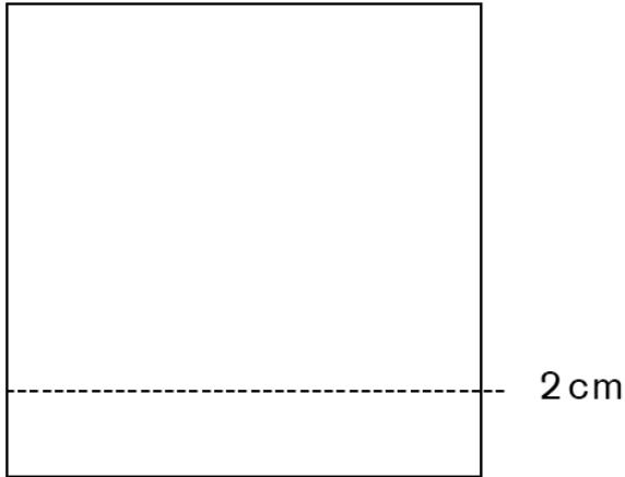
4. von der unteren Öffnung der Tüte 2 cm abmessen und mit dem Falzbein eine Linie ziehen. An dieser Falzline das ganze einmal nach vorne und nach hinten falten.
